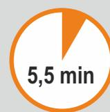
El uso de un resistencia de inmersión de 2000W proporciona un tiempo de calentamiento muy corto: 5 litros en 5,5 min (a  $\Delta t = 25^\circ\text{C}$  de aumento de temperatura).
