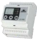
**C.MG module** - Permite el control adicional del sistema de calefacción (suelo radiante). El uso de módulos adicionales de C.MG asegura el control sobre las válvulas mezcladoras, que reducen la temperatura del agua para cada sistema de circulación. Se pueden conectar hasta 24 módulos C.MG a la unidad C.PS.
