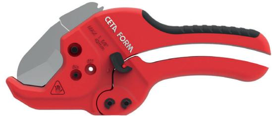
para cortar tubos en PVC, PP, PE, PVDF, PB, PEX y VPE, cuerpo en aluminio, hoja en acero SK5, mango Softgrip
