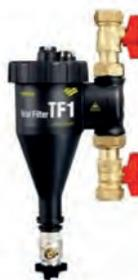
Filtro en línea de alto rendimiento que utiliza una acción hidrociclónica y magnética para eliminar todo tipo de partículas presentes en el agua de los sistemas de calefacción.
