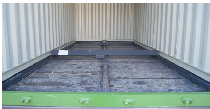
Interior del suelo móvil hidráulico en contenedor
