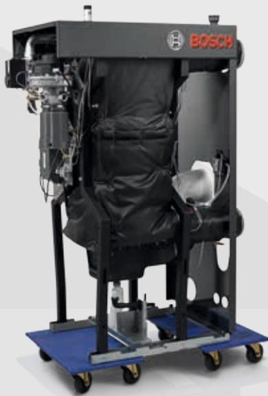
Los **instaladores** se benefician de una estructura en X durante el transporte y la instalación. La caldera puede ser colocada en una plataforma estándar y empujada al lugar de instalación. Muchas piezas como el quemador y los soportes de montaje para la carcasa de la caldera, se pueden desmontar fácilmente para el transporte.
