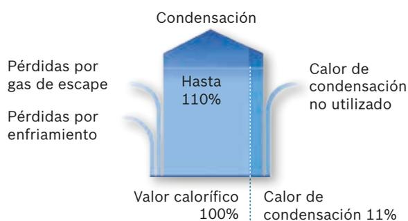
Con tecnología de condensación se puede conseguir un rendimiento superior al 100%, ya que también se utiliza el calor de condensación. La caldera Condens 5000 W ZBR llega hasta un rendimiento del 110%.
